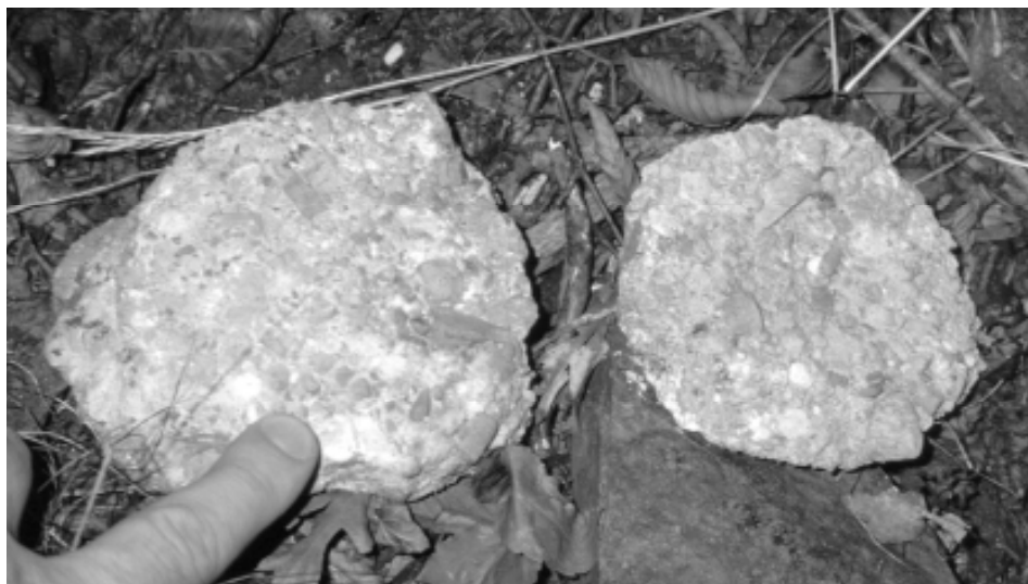
In basso; castello di Casti- glioni: grumi di malta cementizia medioevale
